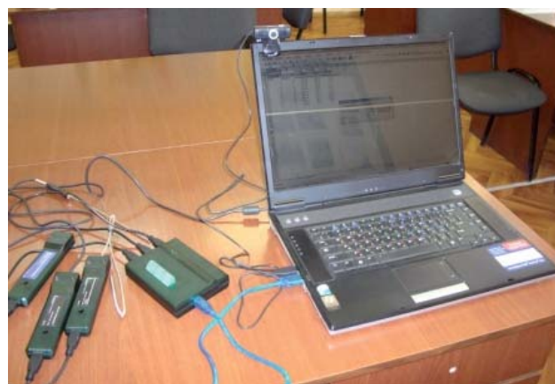
Рис. 2. Лабораторно-исследовательский комплекс, состоящий из датчиков, компьютерного измерительного блока и персонального компьютера.
