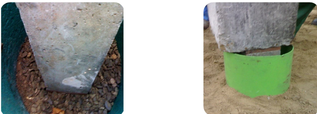
Рисунок 2 – Иллюстрации с места проведения натурных испытаний: 1 – втрамбованный щебень в нижний конец обсадной трубы диаметром 400 мм; 2 – загрузка штампа в обсадной трубе диаметром 300 мм
