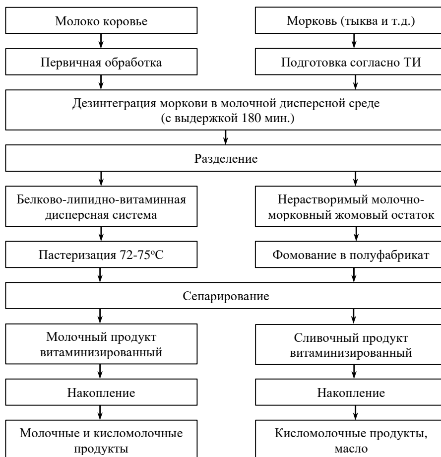
Рисунок 2 – Технологическая схема безотходного получения молочкосодержащих продуктов функционального назначения
