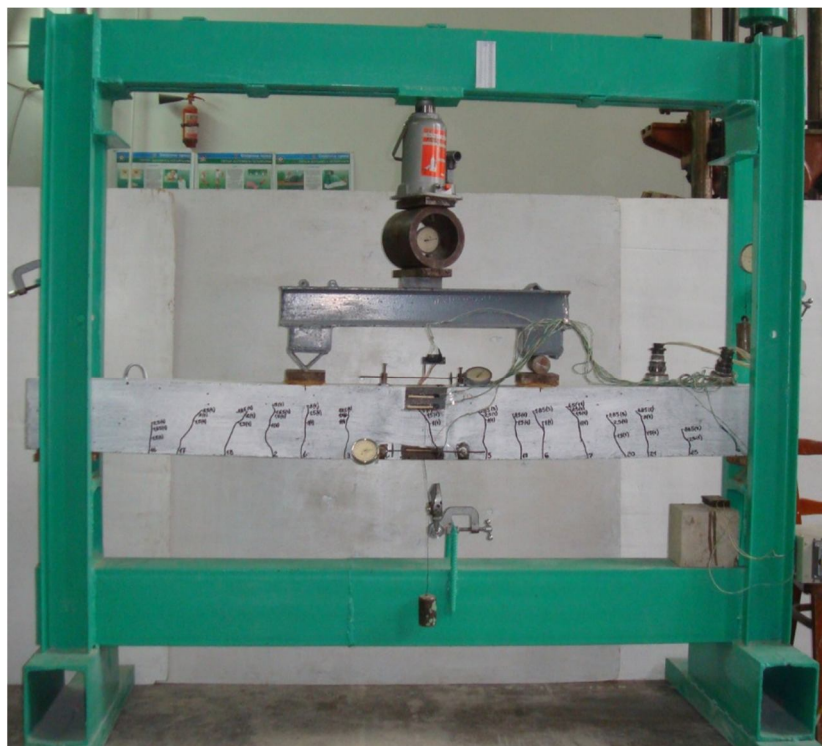
Рисунок 2 – Установка для испытаний железобетонных балок
