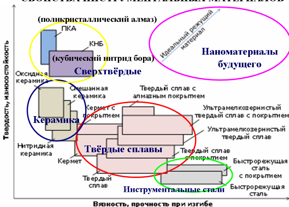
Рисунок 1 – Матрица свойств инструментальных материалов
