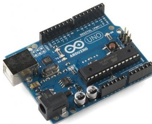
Рисунок 1– Плата Arduino UNO
