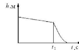
Рис. 2 – График изменения уровня воды в емкости; t_1 – время снижения уровня воды до бокового отверстия
