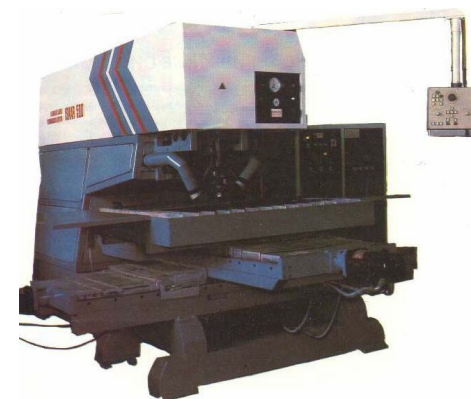
Рисунок 1 – Лазерная технологическая система «Искар-500» на основе газового лазера, предназначенная для резки материалов толщиной до 5 мм (конструкционная сталь)
