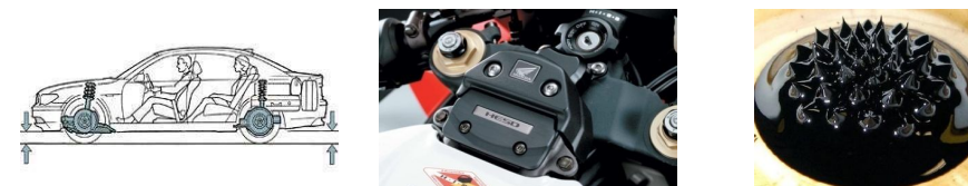
а) - Система электронного управления демпфером EDC; б) – Рулевой демпфер, в) - Магнитоореологическая жидкость
