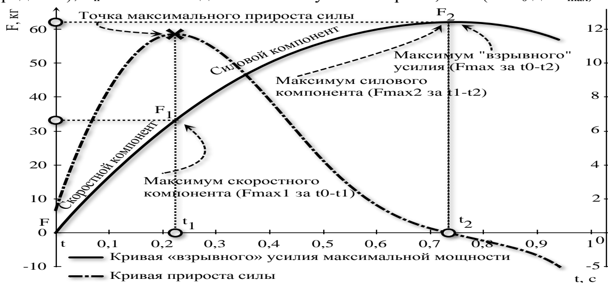
Рис. 1. Принципиальная тензодинамическая запись оценки F(t) при разгибании ног (изометрический режим) у испытуемого
