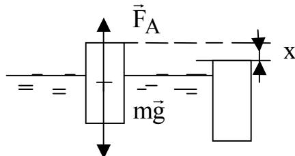
«Гармонической силой», вызывающей колебания поплавка, в данном случае будет разность силы Архимеда и силы тяжести:
