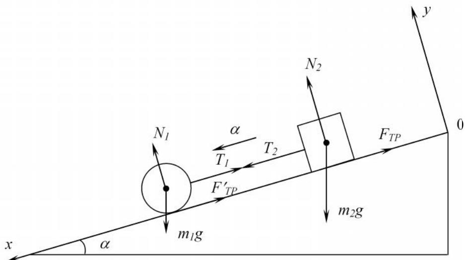
Запишем уравнения второго закона Ньютона в проекциях на оси  $Ox$  и  $Oy$  для цилиндра:
