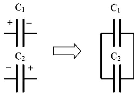
Рассмотрим правые пластины конденсаторов и применим к ним закон сохранения заряда. До подключения их суммарный заряд
