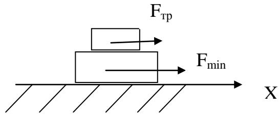
При малых значениях сила  $F$  вызывает совместное ускоренное движение обоих грузов
