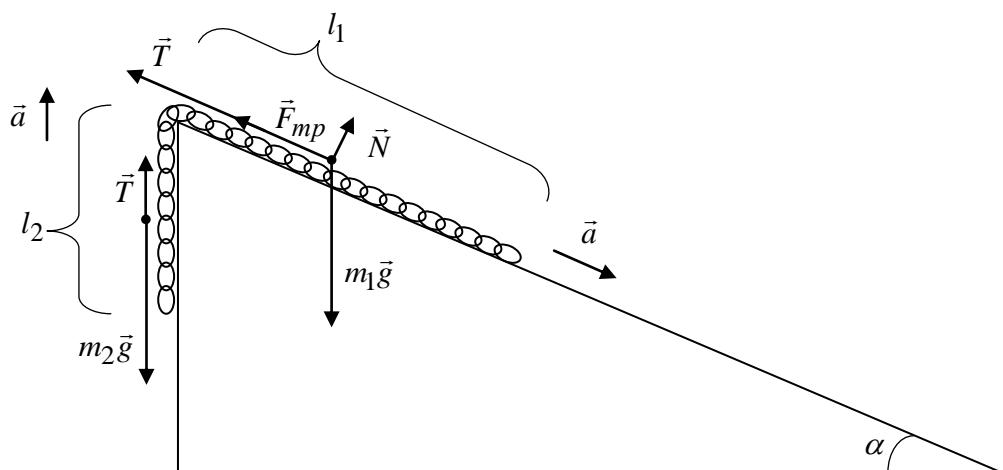
Рисунок, показывающий силы, действующие на цепочку при ее скольжении вверх по наклонной плоскости:
