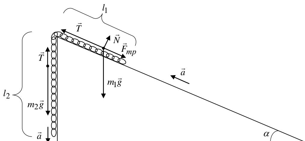
Пусть масса лежащей на наклонной плоскости части цепочки равна  $m_1$ , а висящей вдоль вертикального катета  $m_2$ .
